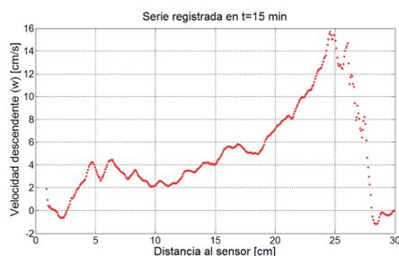
**Figura 5(a).** Perfil de la componente vertical de velocidad (flujo descendente) frente a la pila.
