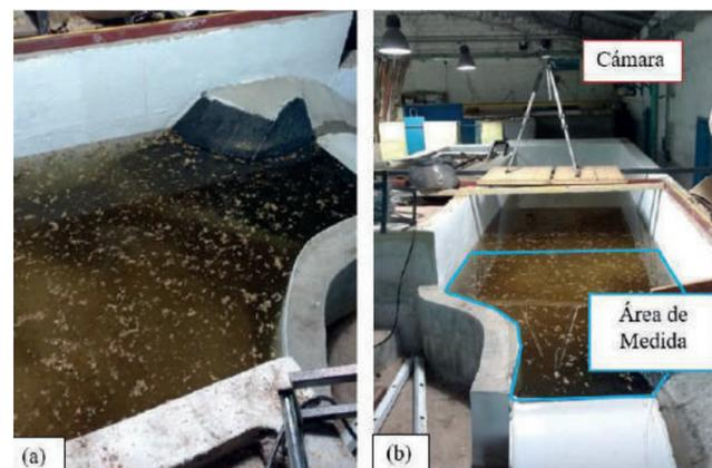
Figura 6. (a) Sembrado de partículas para LSPIV (b) Ubicación de la cámara y zona de medición.
