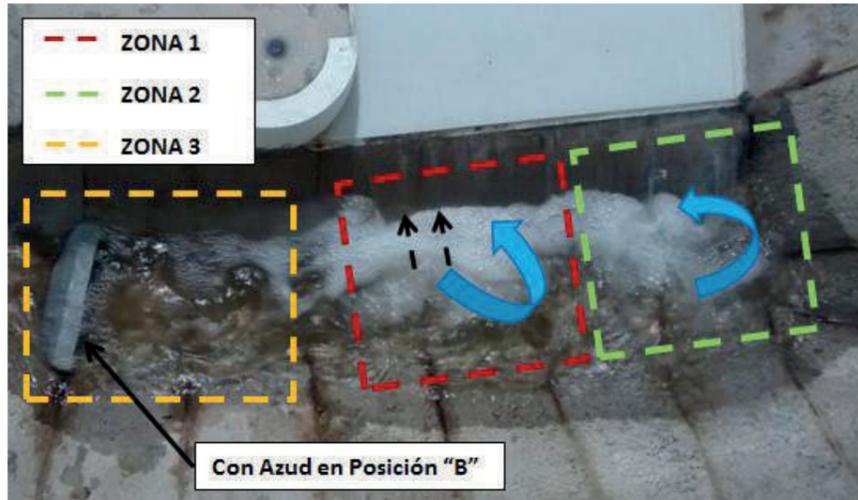
Figura 13. Imagen del flujo aguas abajo del vertedero – Ensayo N° 17 – Con Azud “B”.
