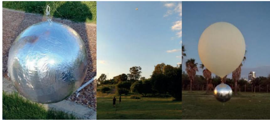
**Figura 3.** Blanco utilizado para la prueba de calibración. La imagen central es una foto tomada en el parque Sarmiento de la Ciudad de Córdoba el día de la prueba experimental. En dicho instante el blanco de calibración se encontraba a 130m de altura. A la derecha se observa la esfera reflectante suspendida por uno de los globos utilizados como medios de elevación.
