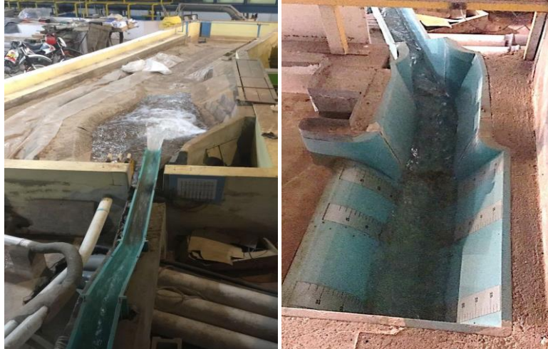
-Modelo Defensas Semisumergidas Mar del Plata , 2010, Froude, Escollera Móvil, 2DV (abajo)
