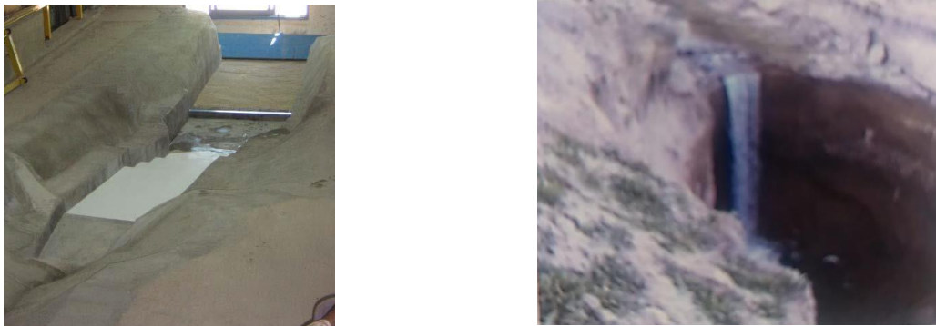
-Modelo Protección Cárcava Arroyo Suco , Cba, 2005, Froude, Fondo Móvil, 3D
