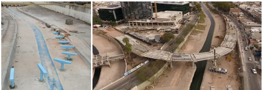
-Modelo Vertedero y cauce Presa Los Alazanes , Córdoba, 2019, Froude, Fondo Fijo, 3D
