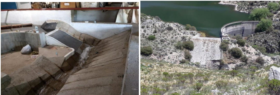
-Modelo Vertedero y cauce Presa Los Alazanes , Córdoba, 2019, Froude, Fondo Fijo, 3D
